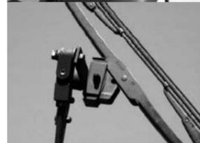
En plus, à cause de ce mouvement, les essuie-glaces peuvent se détacher de la fixation et être perdus. (voir à gauche)
