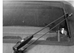
La série de fabrication 460 (loc 2000), le Bt (EW IV et IC 2000) dispose d'un essuie-glace pneumatique. Dès que l'essuie-glace est arrêté et le véhicule branché sur la conduite d'air principale (dispose d'air), l'essuie-glace est mis en position de «parcage» et retenu sur le côté extérieur du véhicule pneumatiquement (voir image à gauche).
