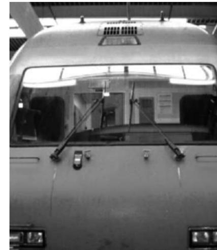
Image: Un véhicule de commande avec l'essuie-glace en position d'arrêt «centrale» aux ateliers d'Olten
