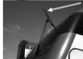
Depuis que sur la NBS on roule à 200 km/h, on a pu observer dans différents cas des essuie-glaces disloqués sur le véhicule de queue et sur le véhicule moteur. Ce phénomène a probablement lieu lors de la rencontre de trains à très grande vitesse (voir image à gauche).
