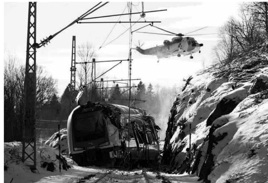
C'est sur la ligne en direction de Vestfold (entre Drammen et Skien) au nord de la gare de Nykirke, dans le parc naturel de Tangenbekken, que le NSB-FLIRT BM 74 105/74 505 a déraillé, le 15 février 2012. Le train 12926 était en phase d'essais quand il a déraillé dans un contour, avant de percuter une falaise. Une voiture de du train automoteur a basculé, trois wagons ont déraillé et tout le train a été gravement endommagé.
