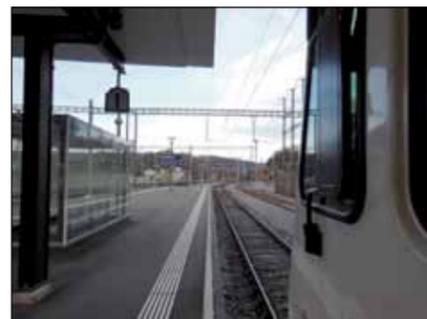
A Koblenz, voie 4 le signal de sortie resp. le signal de tronçon côté sortie présente l'image exécution de vitesse 40 km/h.
