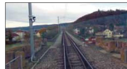
C'est à ce moment que nous franchissons la frontière et apercevons le premier signal allemand: Exécution 50 km/h (Lf 7 signal de vitesse 20002860 3.2.2). Selon RADN la vitesse maximale est de 40km/h.
