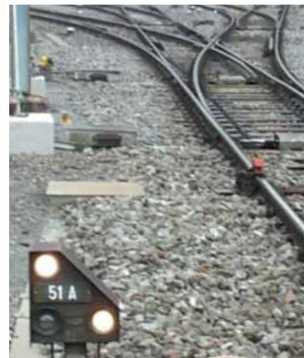
**Signalisation inadaptée lorsque le sabot dérailleur est en place CFF Infrastructure, Installations de sécurité et surveillance des trains.**
