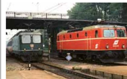
Lindau sur le lac de Constance 2.10.1983 La locomotive suisse a deux largeurs de pantographes différents. CFF Re 4/4 11200 et 1044 ÖBB
