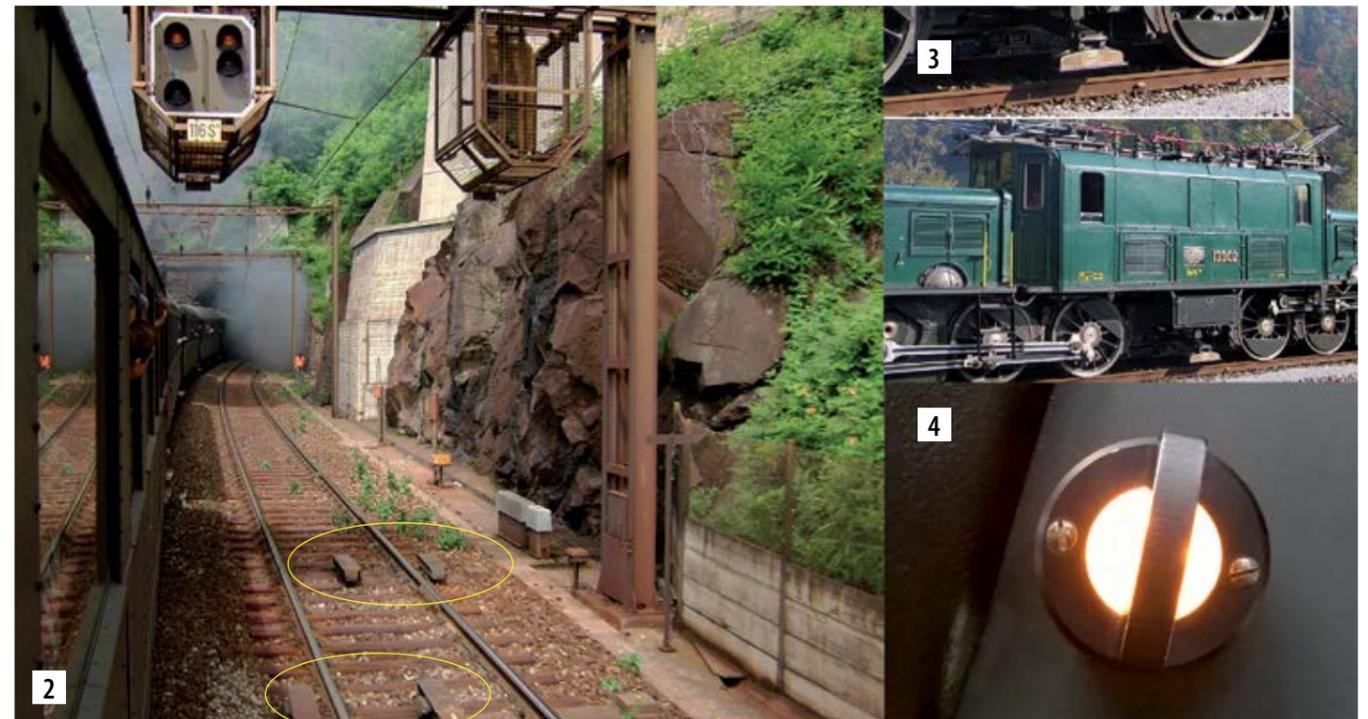
12 Tote und 103 Verletzte. Nun wurde die «Haltauswertung» eingeführt. Das System konnte neu zwischen «Warnung» und «Halt» unterscheiden. Beim Überfahren eines «Halt» zeigenden Signals löste das System eine Schnellbremsung aus. Doch auch dieses System hatte noch Schwachstellen. Die Schnellbremsung erfolgte erst NACH dem Überfahren des Halt zeigenden Signals.
