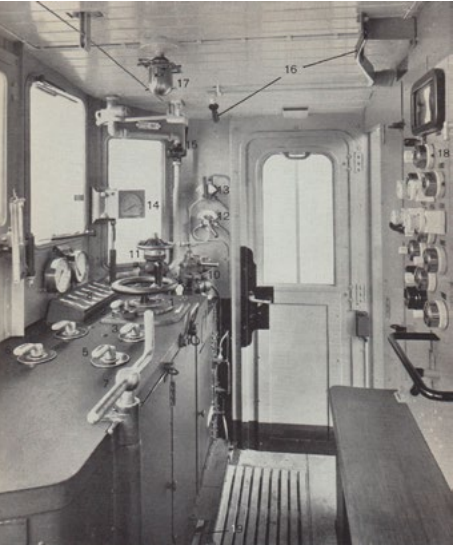
Führerstand einer Ae 4/7 von 1927. Totmannpedal pos. 19.
