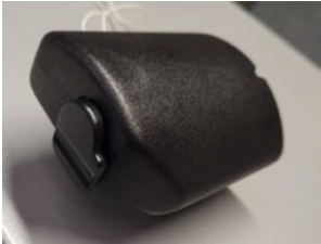
Neuer Taster im Handgriff einer Re 460
