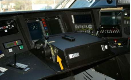
Führerstand TGV POS. Gelber Pfeil: Mit dem Finger zu berührende Metallplatte, welche parallel zum Pedal bedient werden kann. Sie erlaubt auch die stehende Bedienung des Zuges.
