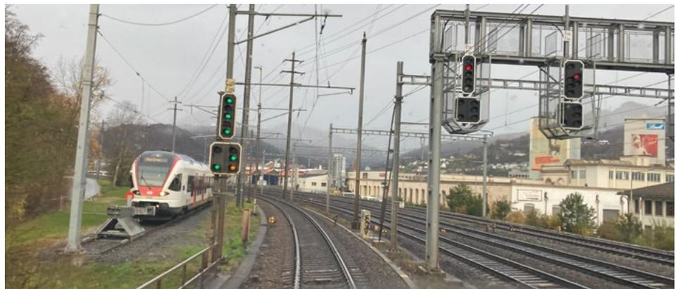
Signal principal de tronçon d'entrée en gare. À partir d'ici, le mécanicien de locomotive respecte la vitesse de 90 km/h annoncée au signal avancé.
