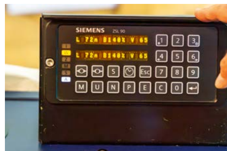
Das Dateneingabegerät für ZSL 90, der Zug ist 72 m lang, hat 140 Bremsprozent und eine Vmax von 65 km/h.
