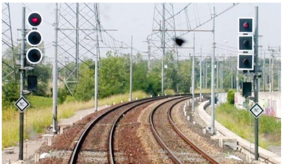
Bild 5: Links- / Rechtsaufstellung von Signalen in Italien. Links rund, rechts quadratisch.
