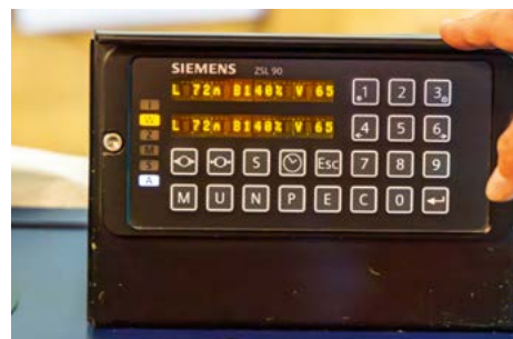
Le dispositif de saisie des données pour le ZSL-90, le train mesure 72 m de long, a un rapport de freinage de 140 % et une vitesse maximale de 65 km/h
