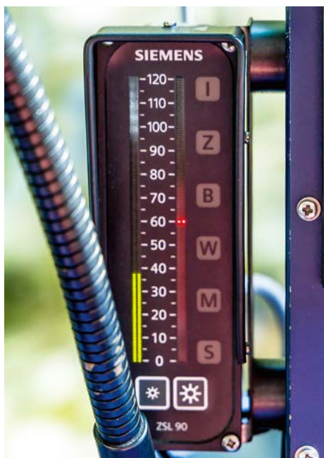
Il display ZSL-90. Il treno viaggia a 37 km/h, con controllo impostato a 60 km/h
