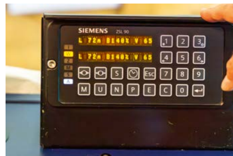
Il dispositivo di inserimento dati per lo ZSL-90: il treno è lungo 72 m, ha una forza frenante del 140% e una velocità massima di 65 km/h
