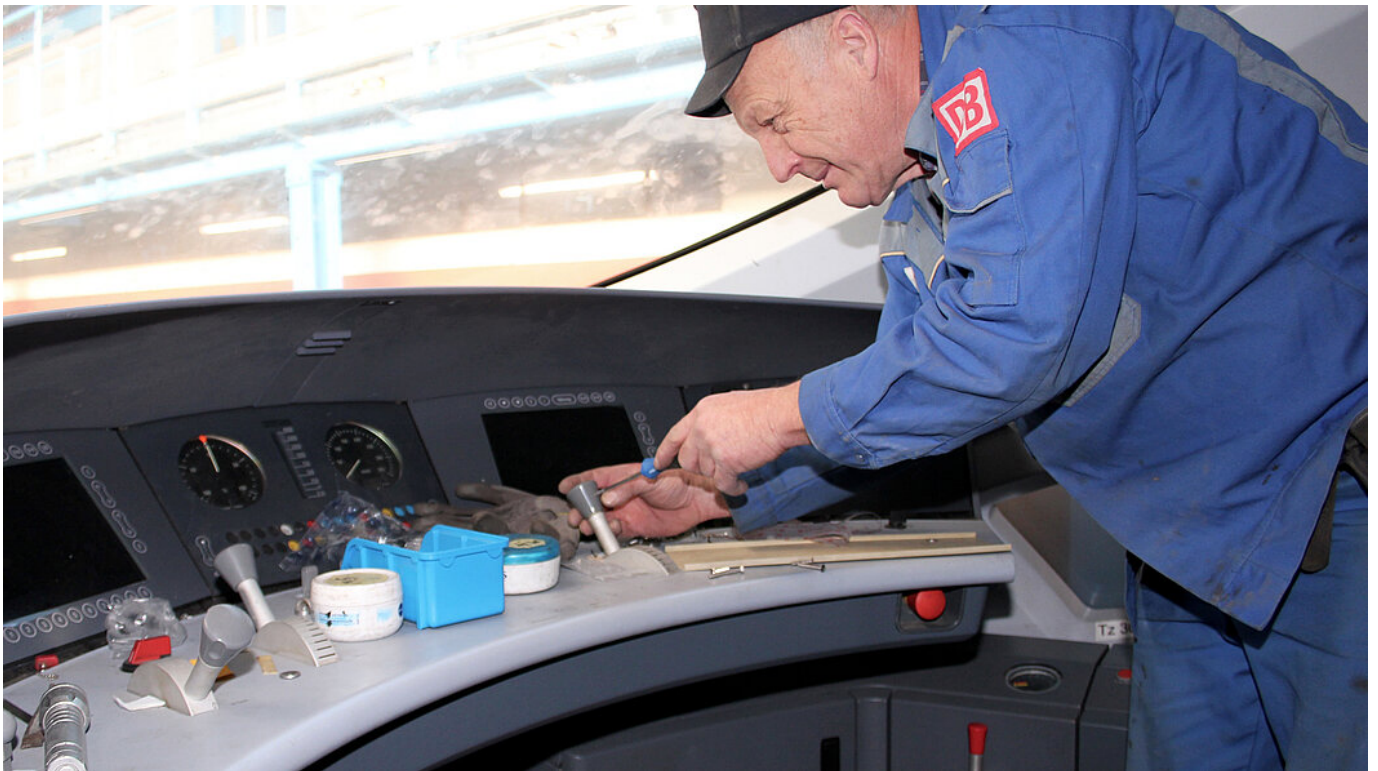
Ein Mitarbeiter der DB Fahrzeuginstandhaltung rüstet Züge mit dem Europäischen Zugkontrollsystem (ETCS) aus. (Foto: DB AG/C3 - aw)
