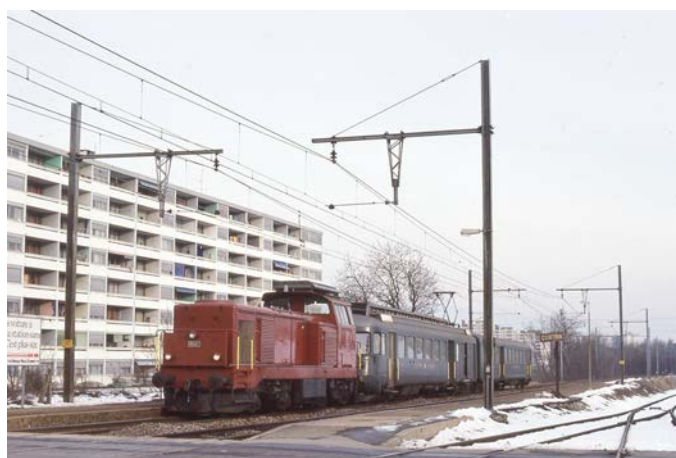
(image 8) Au début il s'agissait d'une locomotive diesel remorquant une automotrice avariée afin que celle-ci assure au moins le chauffage du train à défaut de pouvoir le tirer.
