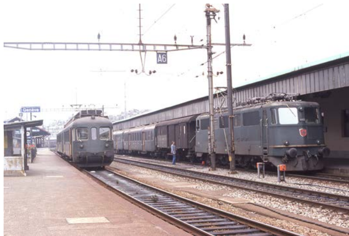
(image 4) Afin d'avoir une solution de rechange on construisit en 1961 un véhicule tricourant hybride en se servant d'une carrosserie d' « Ae 6/6 » et du châssis de la défunte locomotive à gaz. L' « Ae 4/6 III », surnommée « Tricouni » était née.
