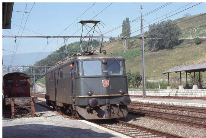
(image 5). Déjà à l'époque cet engin avait donc été prévu pour pouvoir circuler en 25'000 volts sur Annemasse en cas de réalisation de la liaison qu'on appelle aujourd'hui le CEVA .
